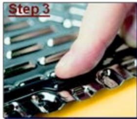
Способ крепления уплотнений EasyClip предназначен для быстрого зажима в установочное место с помощью клипс. Уплотнение жестко фиксировано и остается в сохранности во время работы. Зафиксировать уплотнение на пластине можно всего за 15 секунд. Благодаря системе крепления EasyClip, уплотнение не выходит за границы пакета пластин, таким образом, удастся избежать воздействия на эластомер разрушающих факторов окружающей среды, например, ультра-фиолетового излучения.
